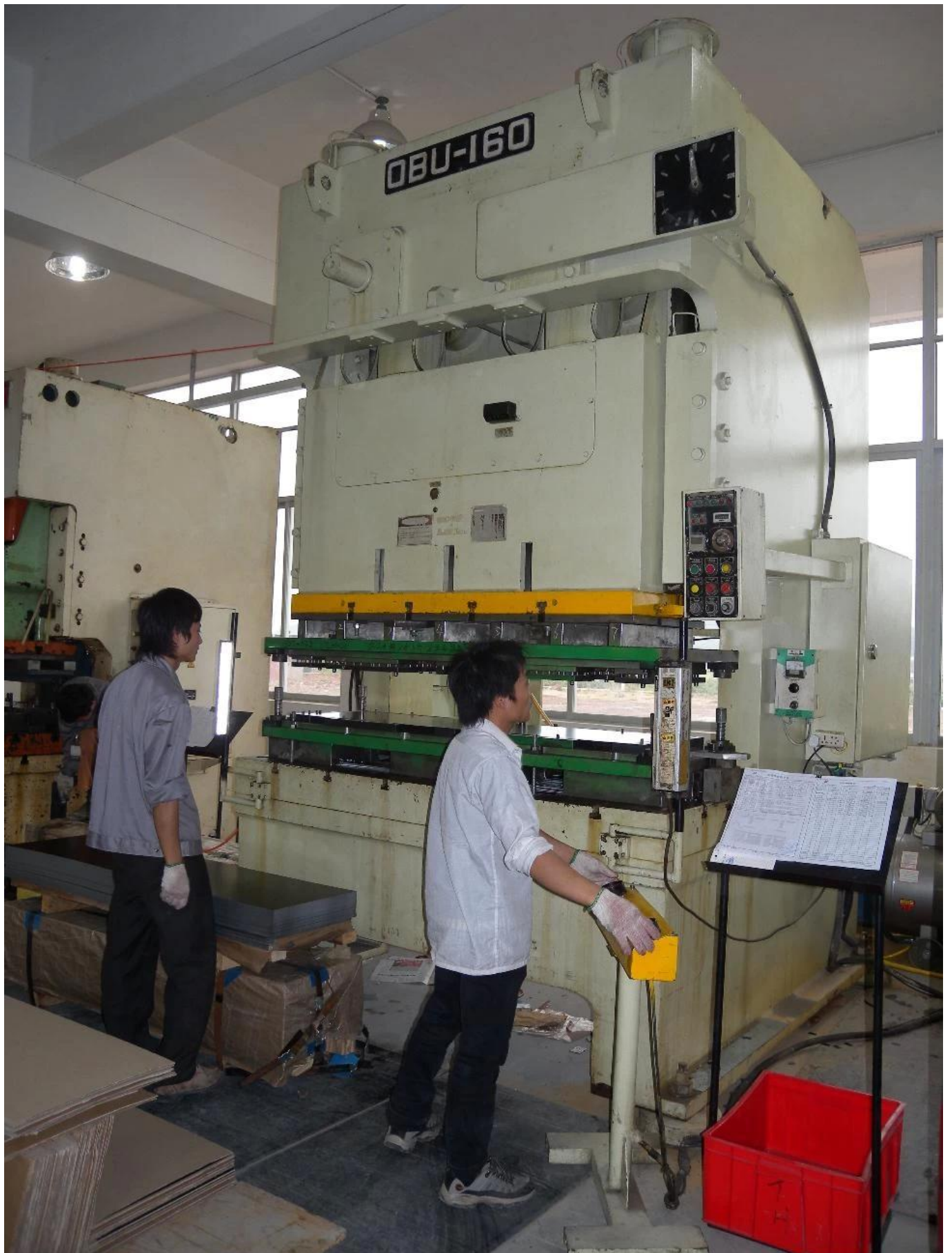
160T 宽台面冲床 模具加工尺寸800*1800mm
