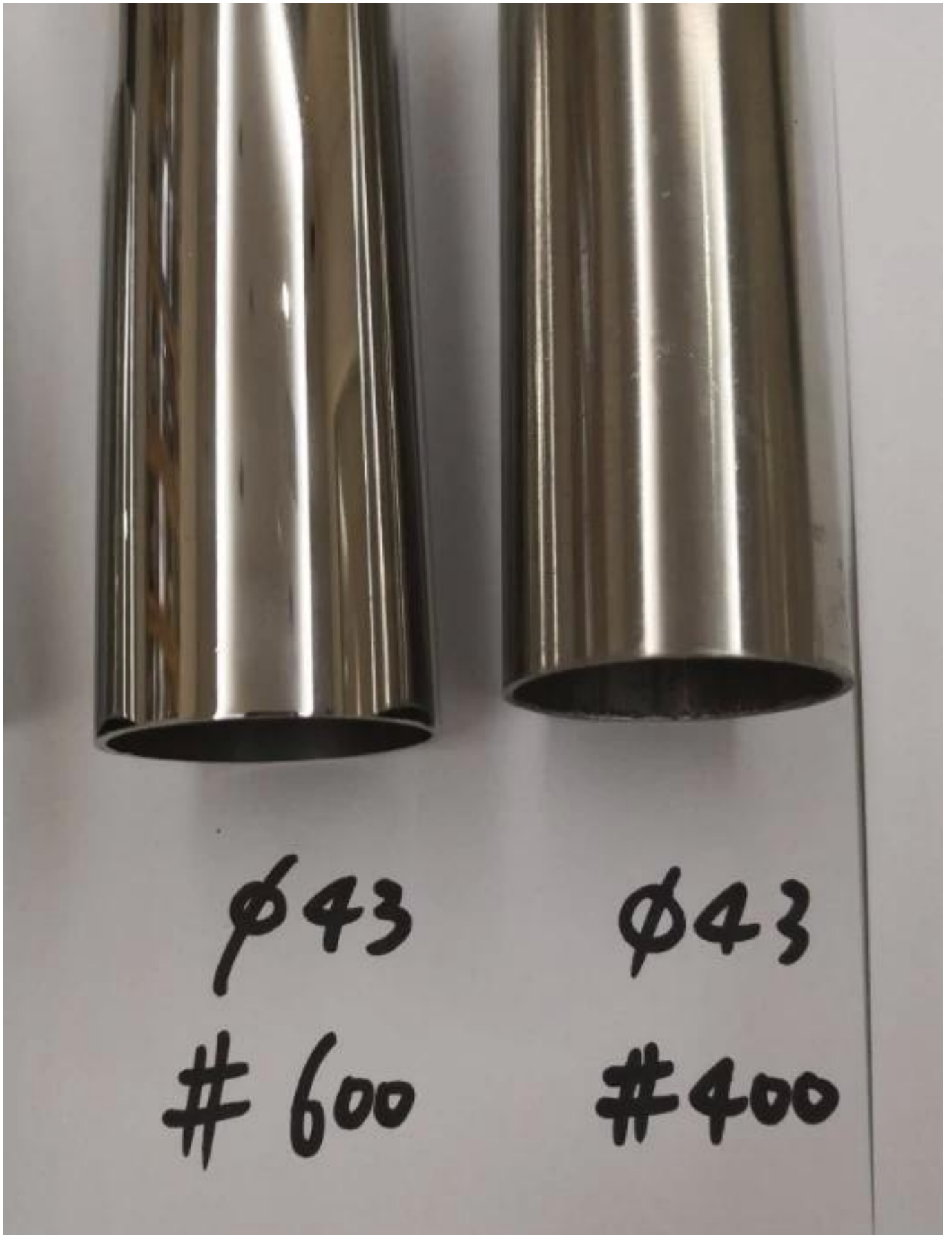
3. Tuotantokuvaukset ruostumattomasta teräksestä valmistetusta kaideputkesta
