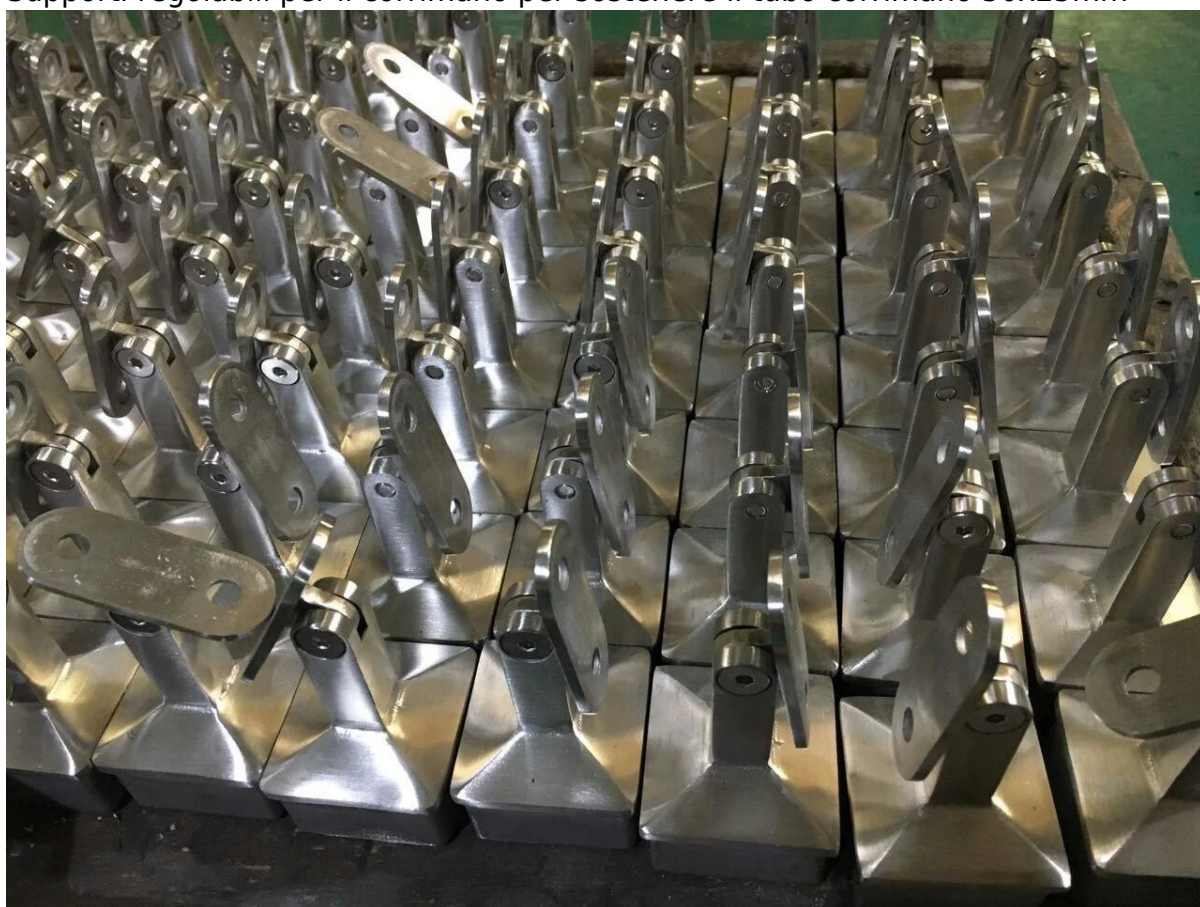
Supporti regolabili per il corrimano per sostenere il tubo corrimano 50x25mm
