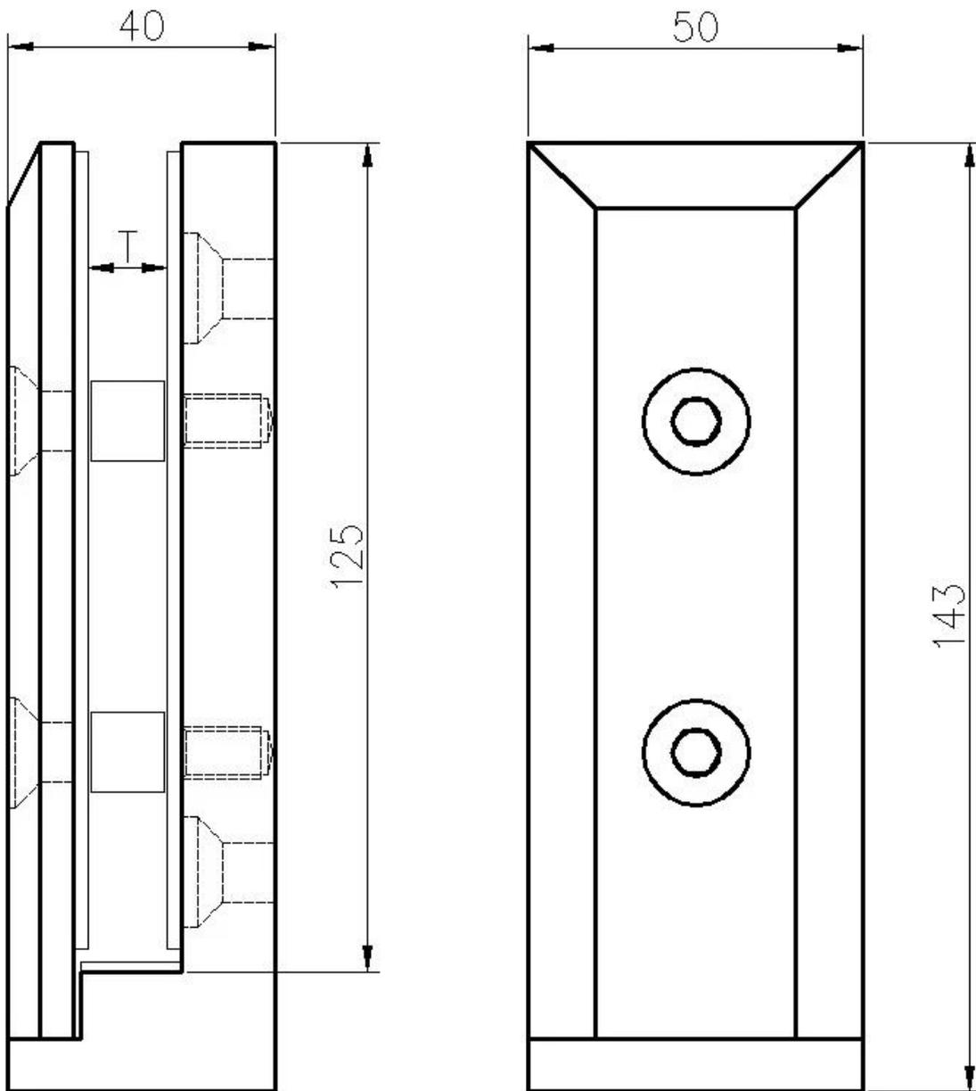
3) Face de parede de aço inoxidável montado em projetos de vidro Smart Spigots
