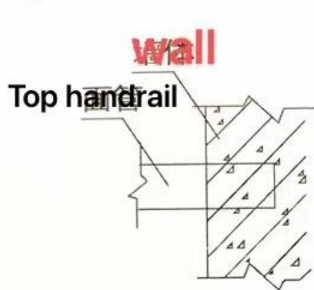
面管入墙固定
