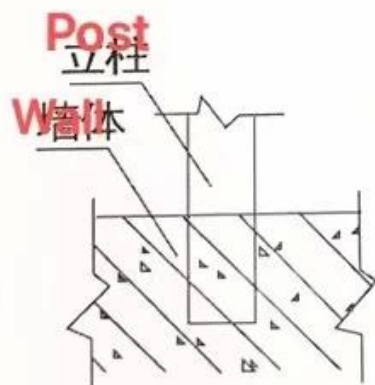
立柱入墙固定
