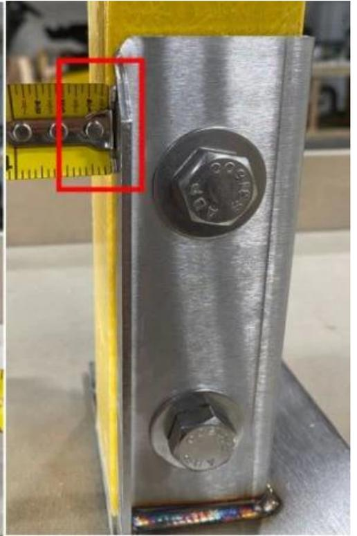
鋼管與鋼板之接合部之構造
