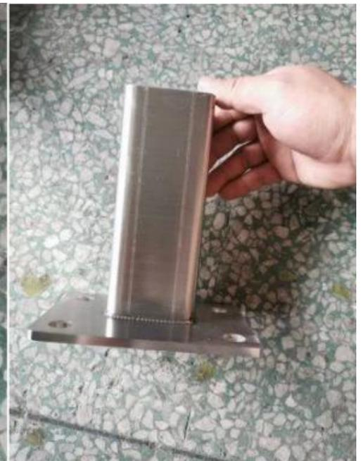
鋼管與鋼板之接合部之構造
