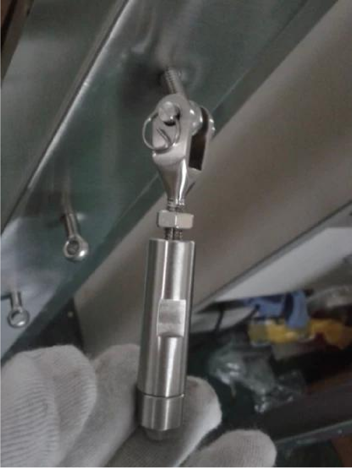
3 JMM 6 mm حجم كابل: 3 1: 19x7، 19x7 نوع الكابل: الفولاذ المقاوم للصدأ 1
