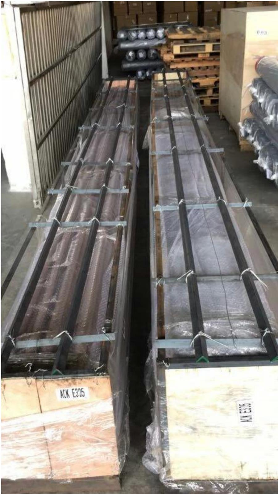
4. Projektfotos für 21x25mm geschliffene Handlaufrohre aus Edelstahl
