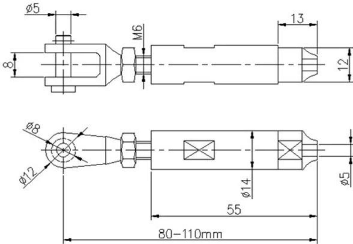
Weitere Modelle von Kabelspannern, die für unterschiedliche Kabeldurchmesser verfügbar sind -
