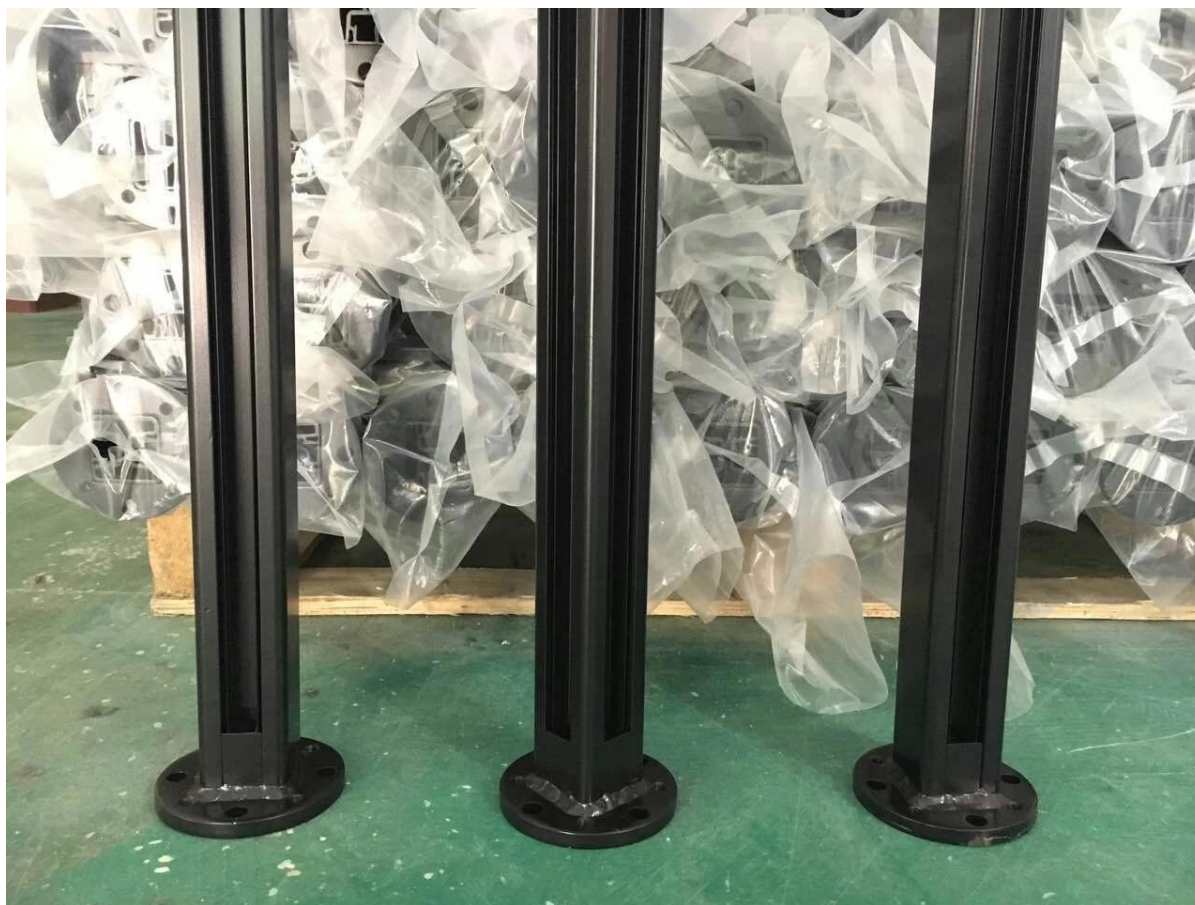
3. Runde halb rahmenloser Glasfechten-Aluminiumpfosten : Durchmesser 50 mm x 3 mm
