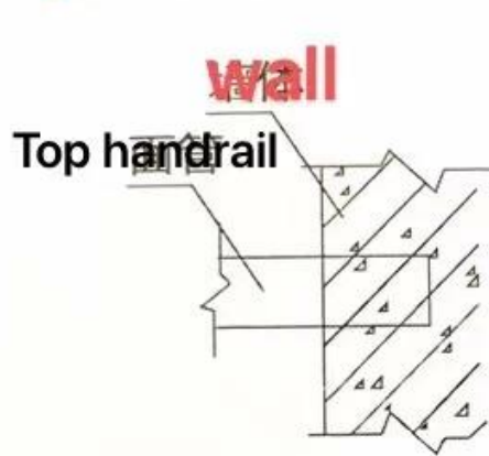
面管入墙固定
