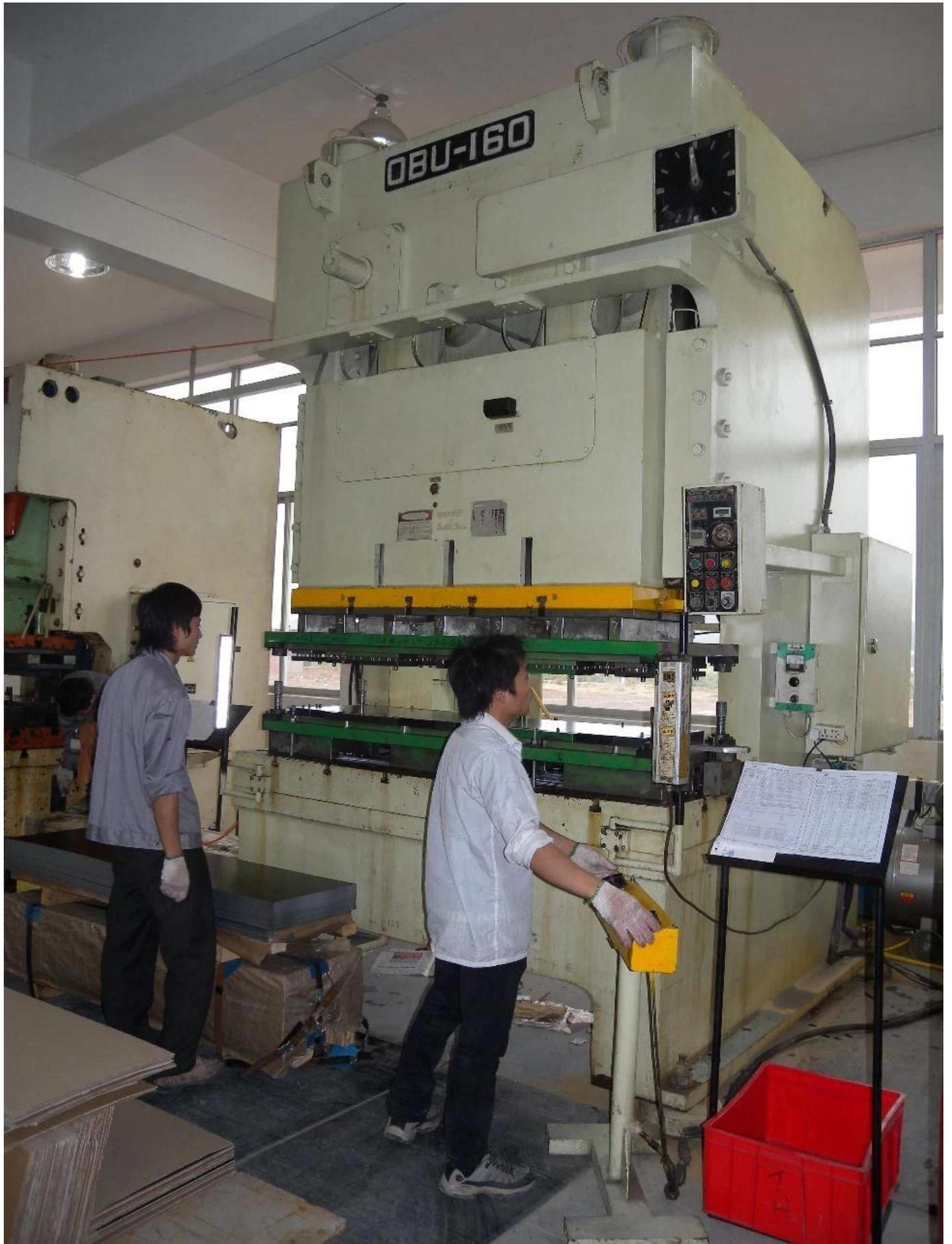
**160T 宽台面冲床** 模具加工尺寸800\*1800mm
