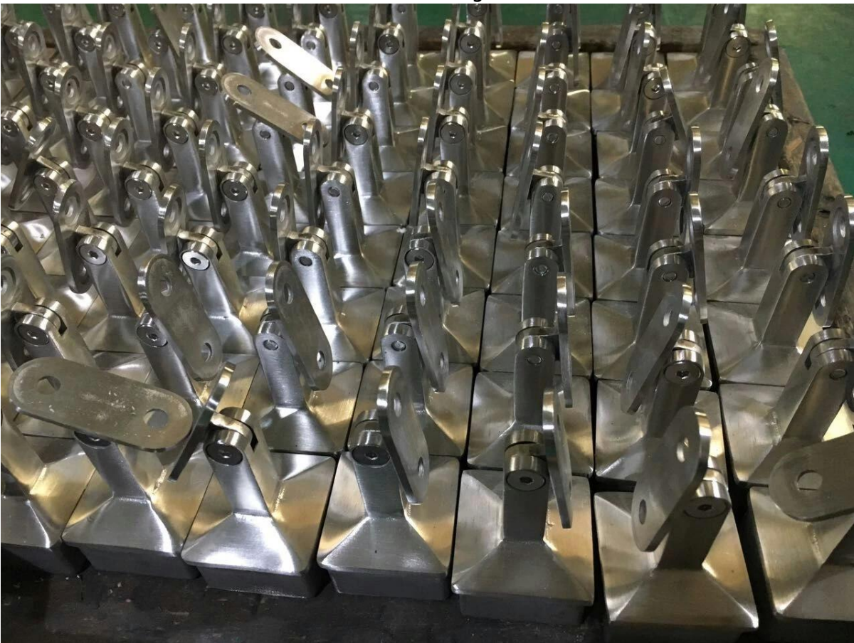
Verstellbare Handlaufleisten zur Unterstützung von 50x25mm Handlaufrohr
