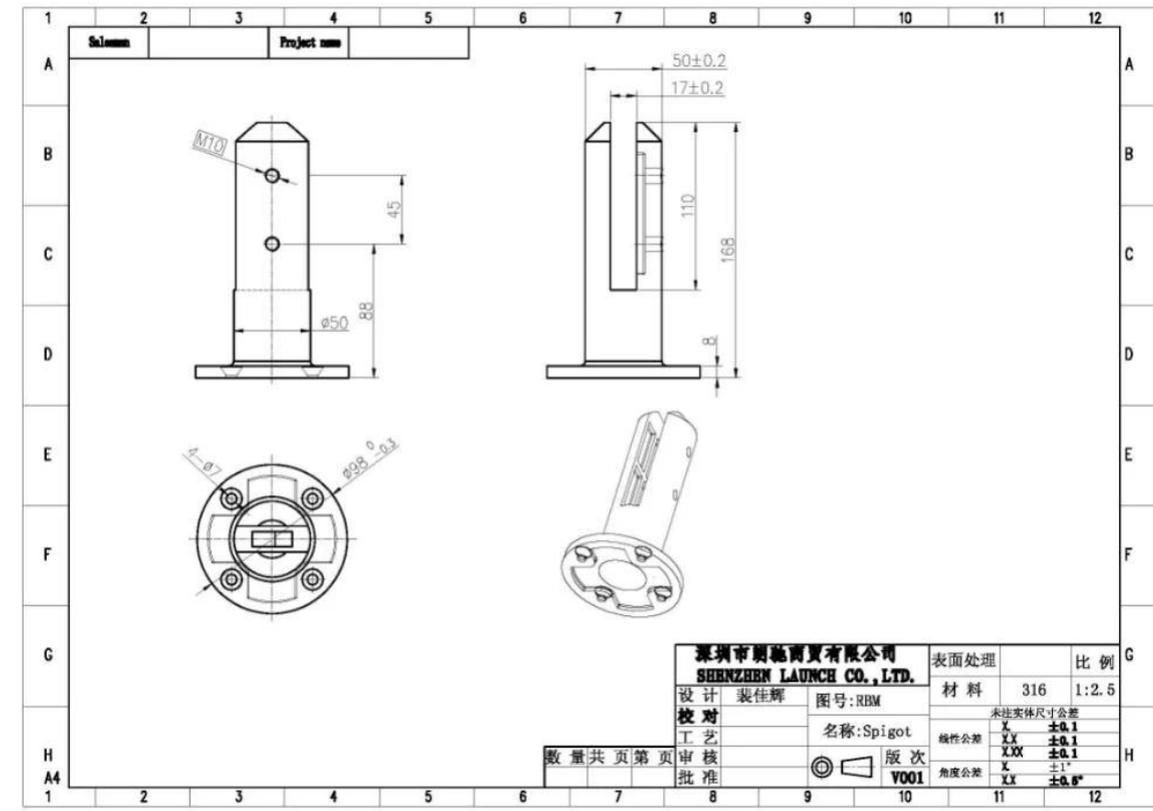
3) Verpackung / Herstellung der oberflächenmontierten Glaszapfenklemme
