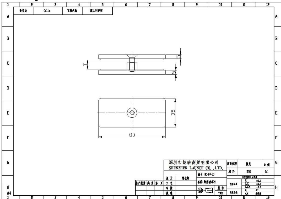
BC-80 \* 35 ist zwischen der Glasplatte 2 verwendet wird, um die Verbindung zu bilden. Stabiler und sicherer;
