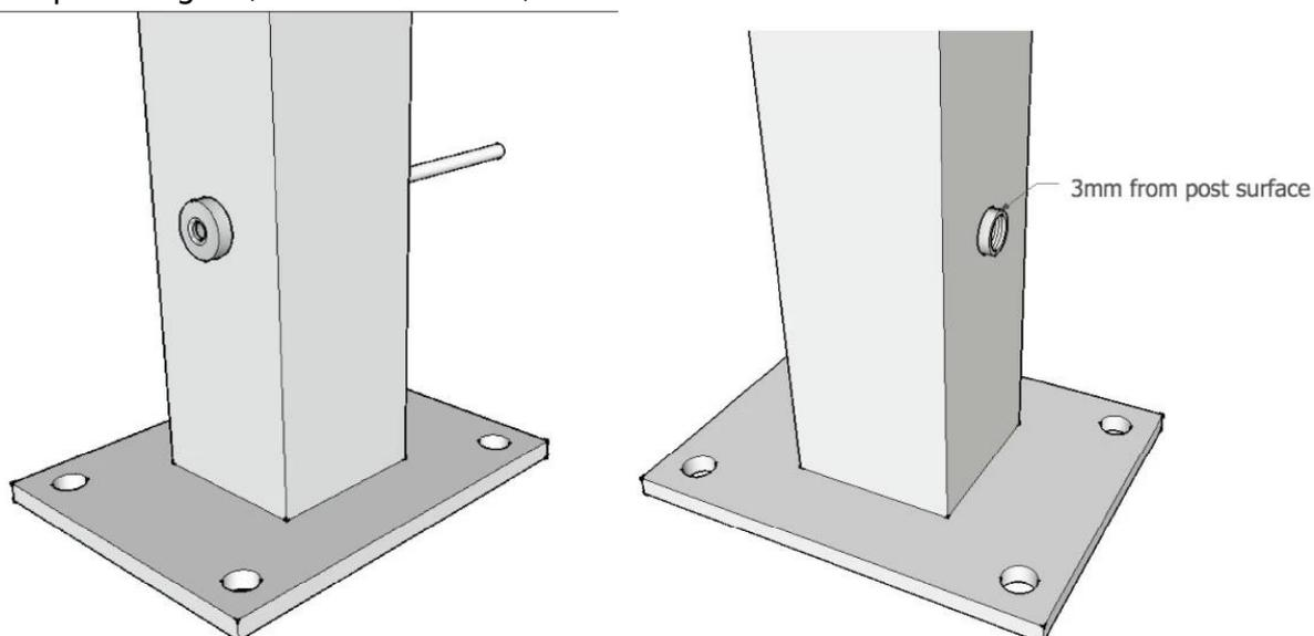
**Keine Notwendigkeit Mutter auf der anderen Seite, wie auch immer, müssen Sie ein Loch an der Stelle für den Seilspanner bohren.**
