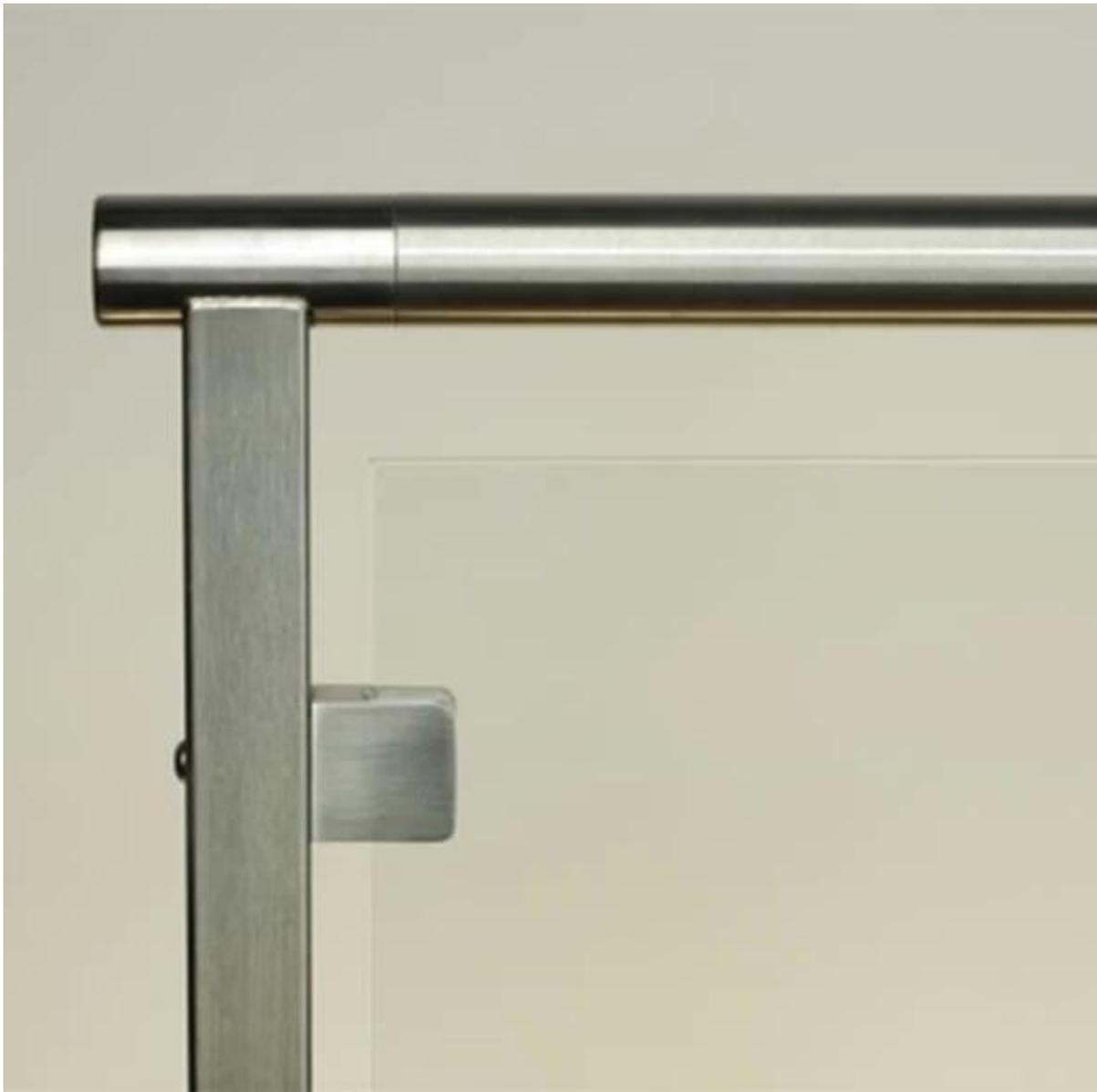
Schritt 2: Schauen Sie sich Schlauchgröße: wenn sein rundes Rohr, lesen Sie bitte Durchmesser des Rohres 42,4 oder 50,8 oder andere. Wir werden die Rundrückenwinkel, um Ihre Post zu passen anpassen. Wenn seine Vierkantrohr wird dann der flachen Rückseite der Glasklemmplatte empfohlen.
