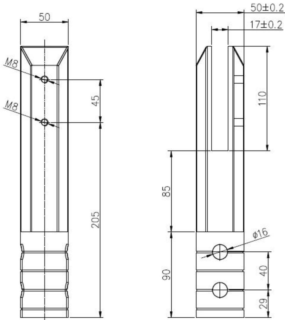
Dieses Modell der Stützen lässt sich für die Pool-Zaun und Balkon Zaun verwendet werden. Es ist viel stärker als Basishalterung Zapfen. Sein schwerer und Größe größer als Basishalterung Modelle. Jeder Zapfen ist ca. 1,9 kg.
