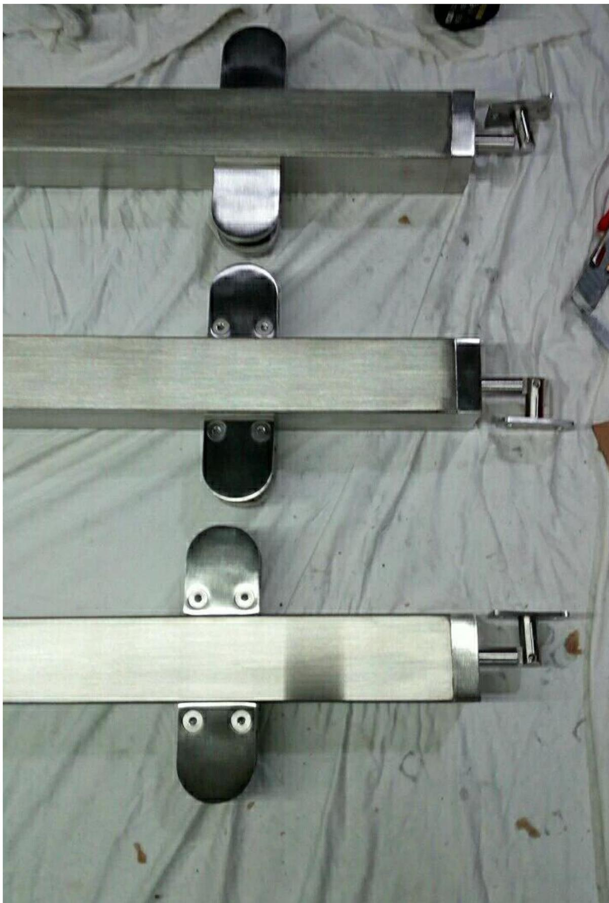
Poste de barandilla de montaje en barandilla / montaje lateral
