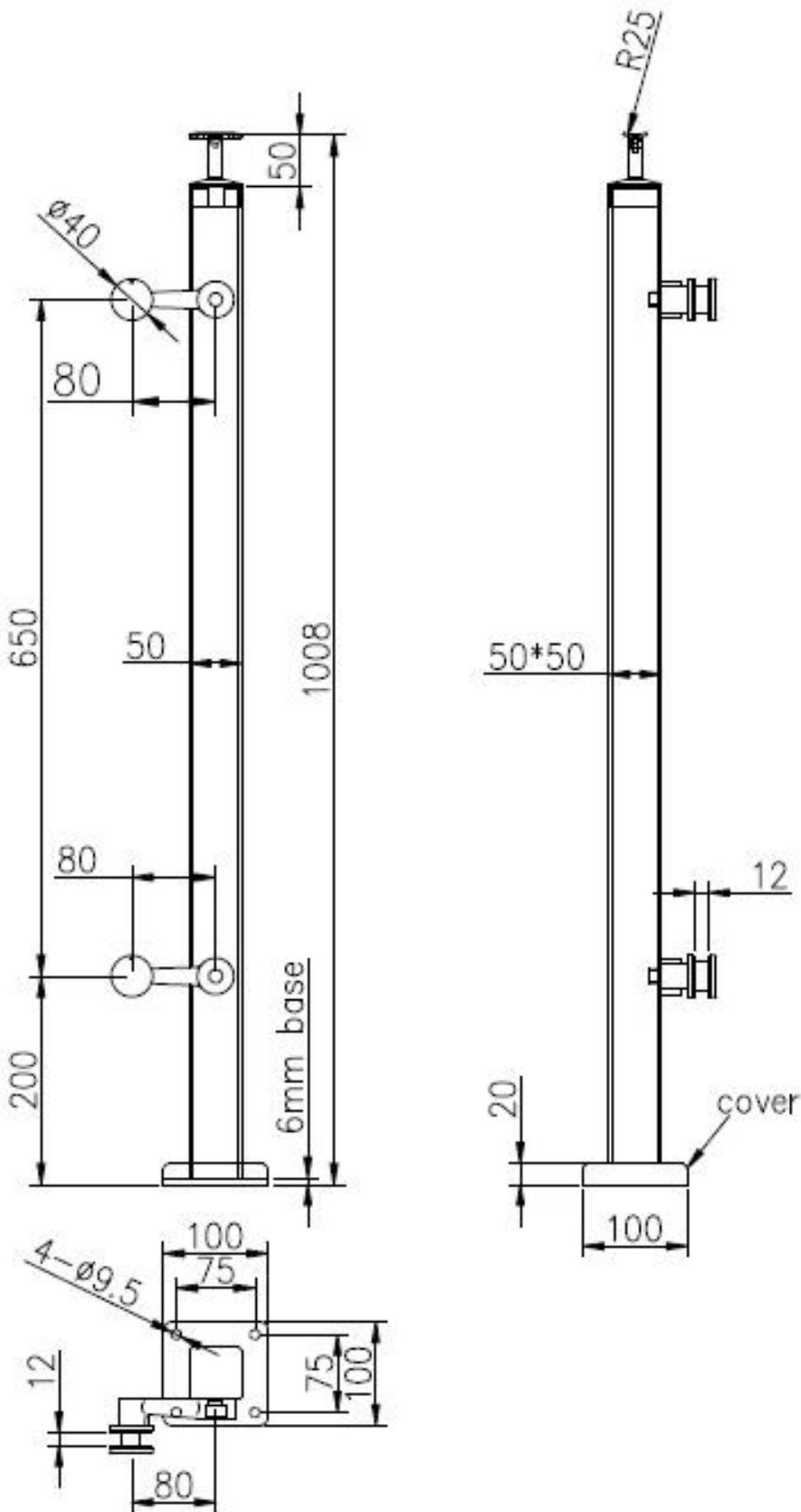
Detalles del dibujo de la instalación de vidrio
