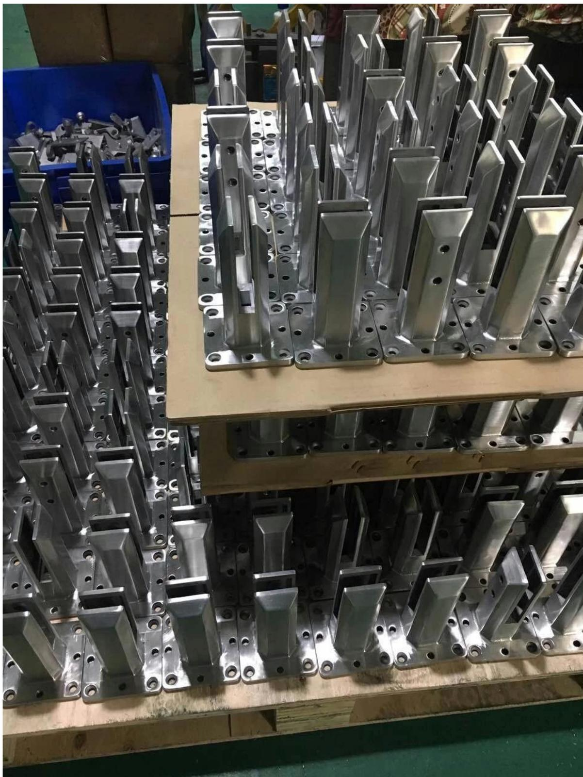
**Fotos del proyecto de las abrazaderas de espigas de balaustrada de balcón de vidrio sin marco Duplex 2205-**
