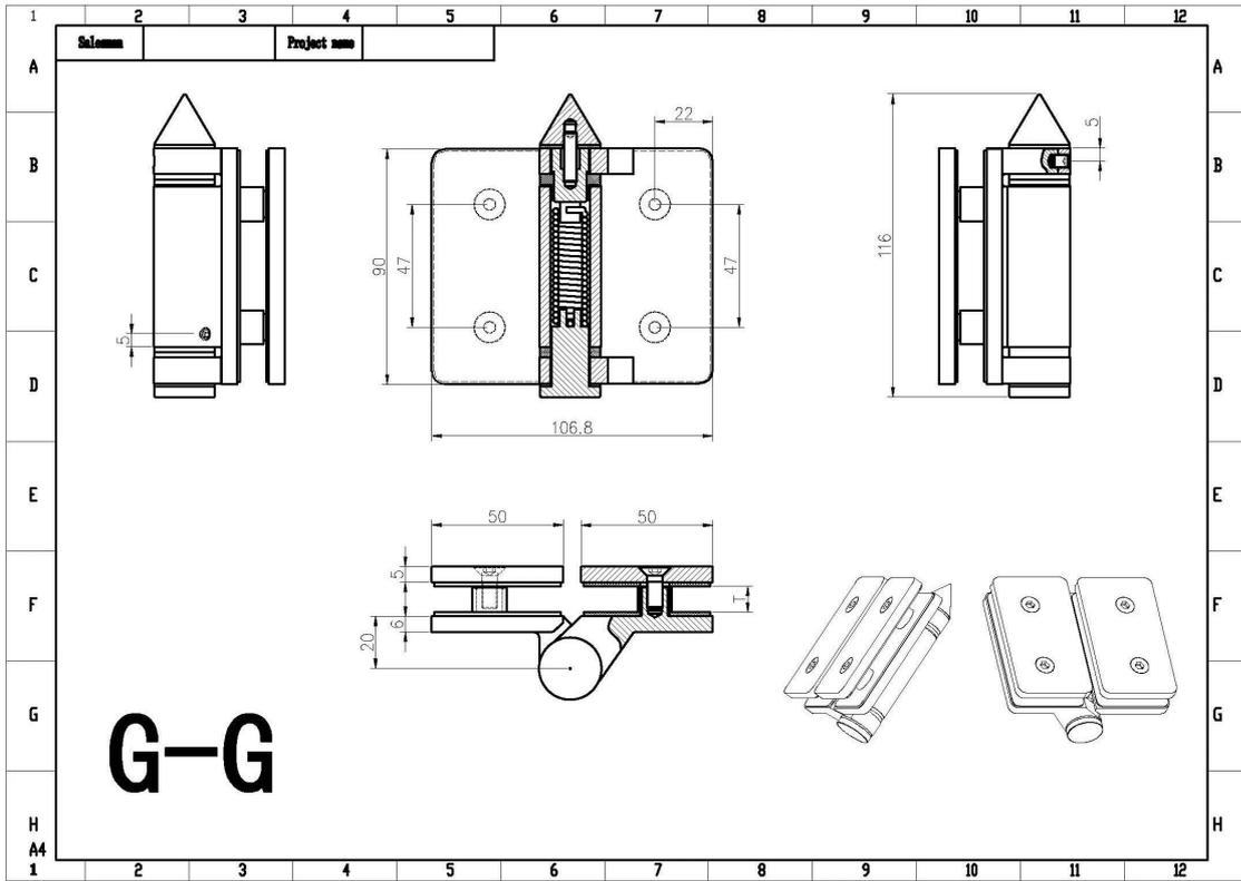
Se requiere un dibujo de orificio de vidrio para la bisagra y el pestillo de vidrio -
