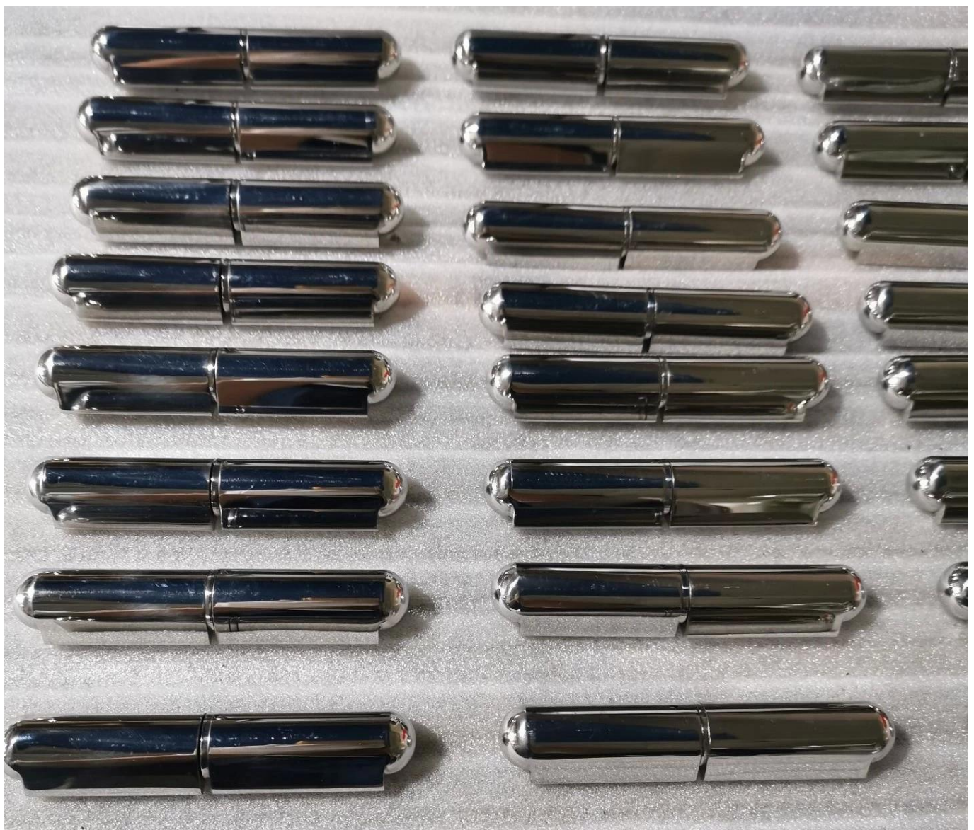
Soldadura de acabado fresado en bisagras:
