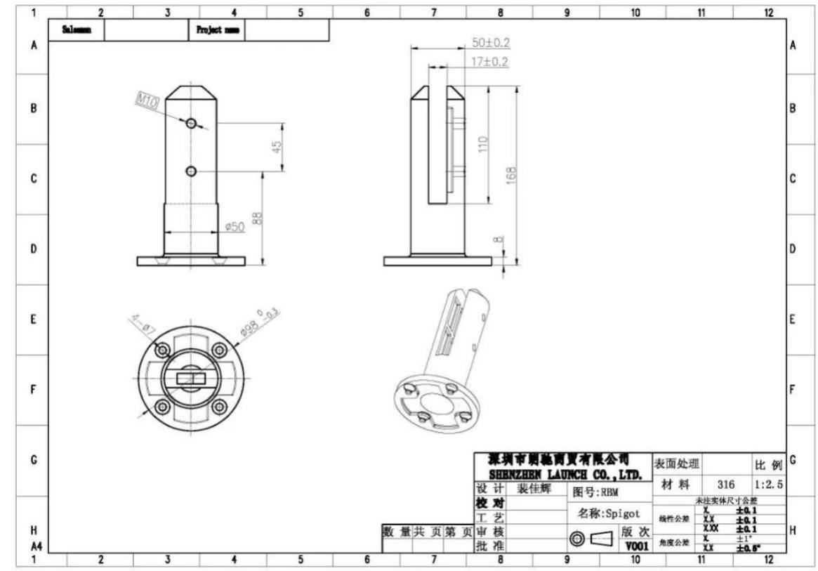
3) Embalaje / producción de abrazadera de espita de vidrio para montaje en superficie
