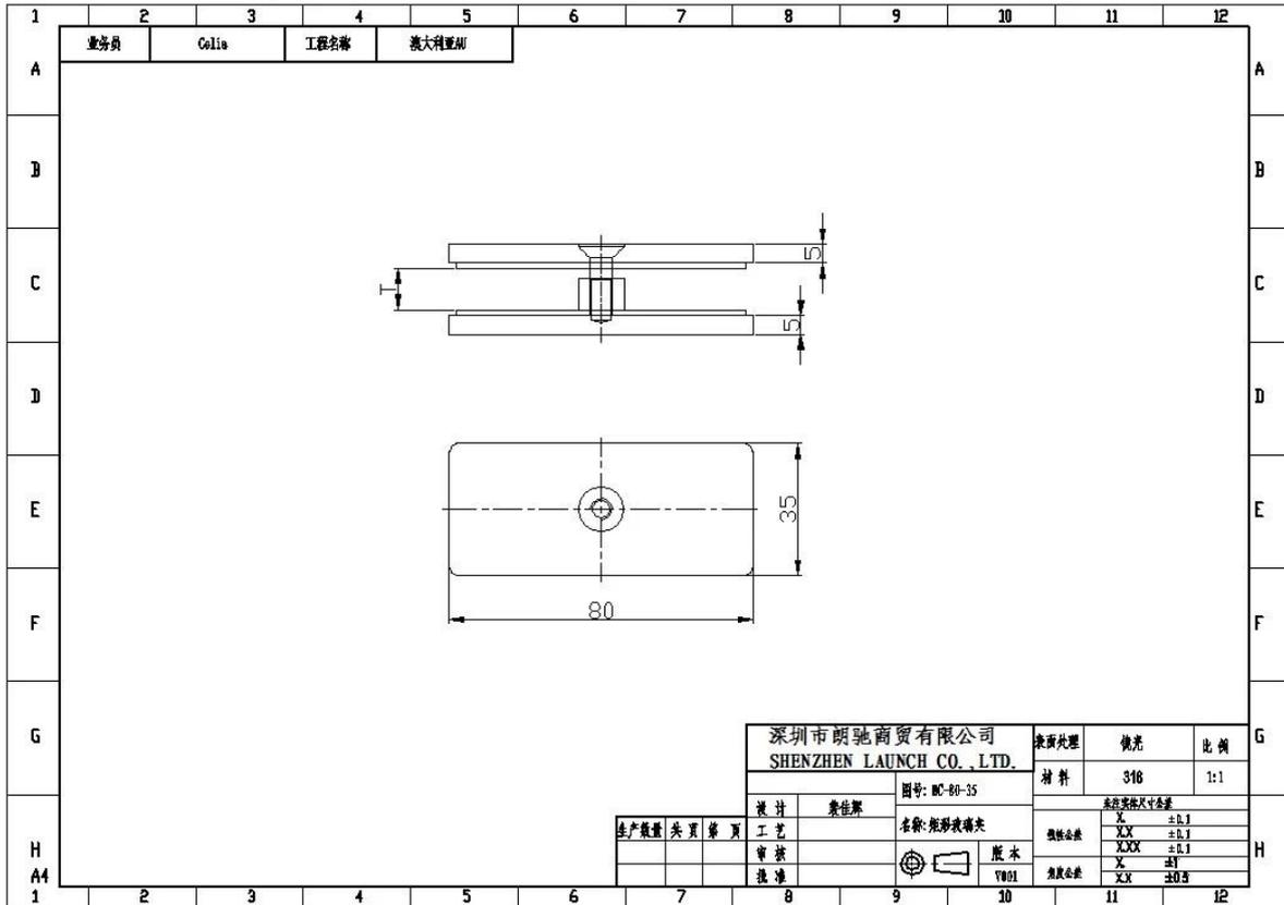
BC-80 \* 35 se utiliza entre el panel 2 de vidrio, para hacer la conexión de ellos.
