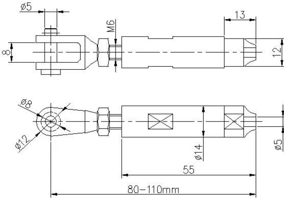
Estructura interna del tensor de cable T803, tipo de clip apretado, no necesita adenas hidráulicas -
