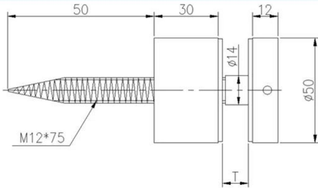
fotos para el soporte separador de vidrio de acero inoxidable cepillado para barandillas de escaleras
