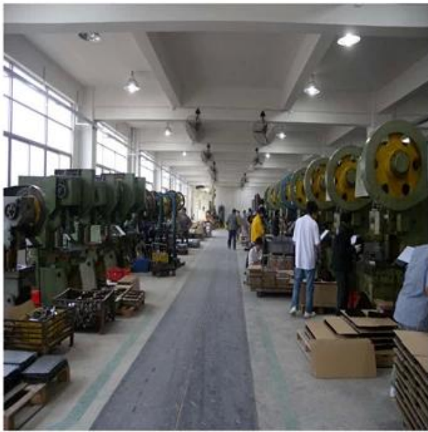
160T 宽台面冲床 模具加工尺寸800*1800mm
