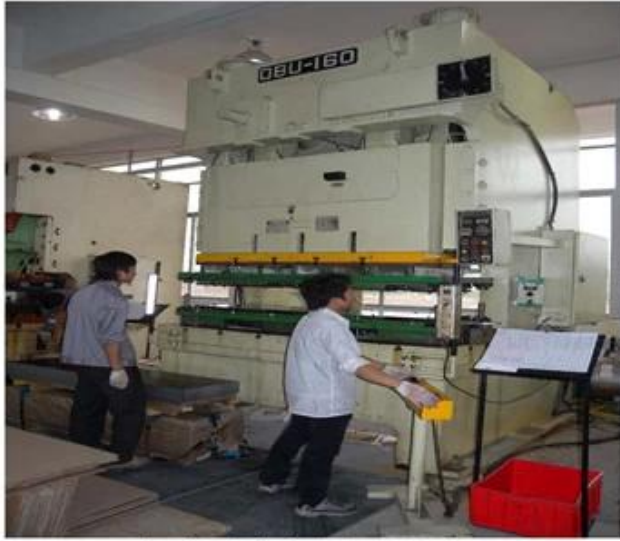
160T 宽台面冲床 模具加工尺寸800*1800mm
