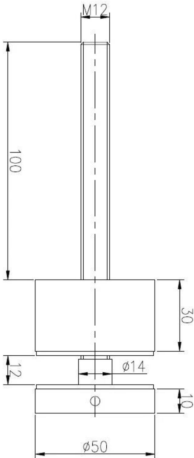
Aplicación: Por lo general, 1 vaso panel de 1200mm x1000mmx12mm debe ser fijado con 4 unidades enfrentamiento
