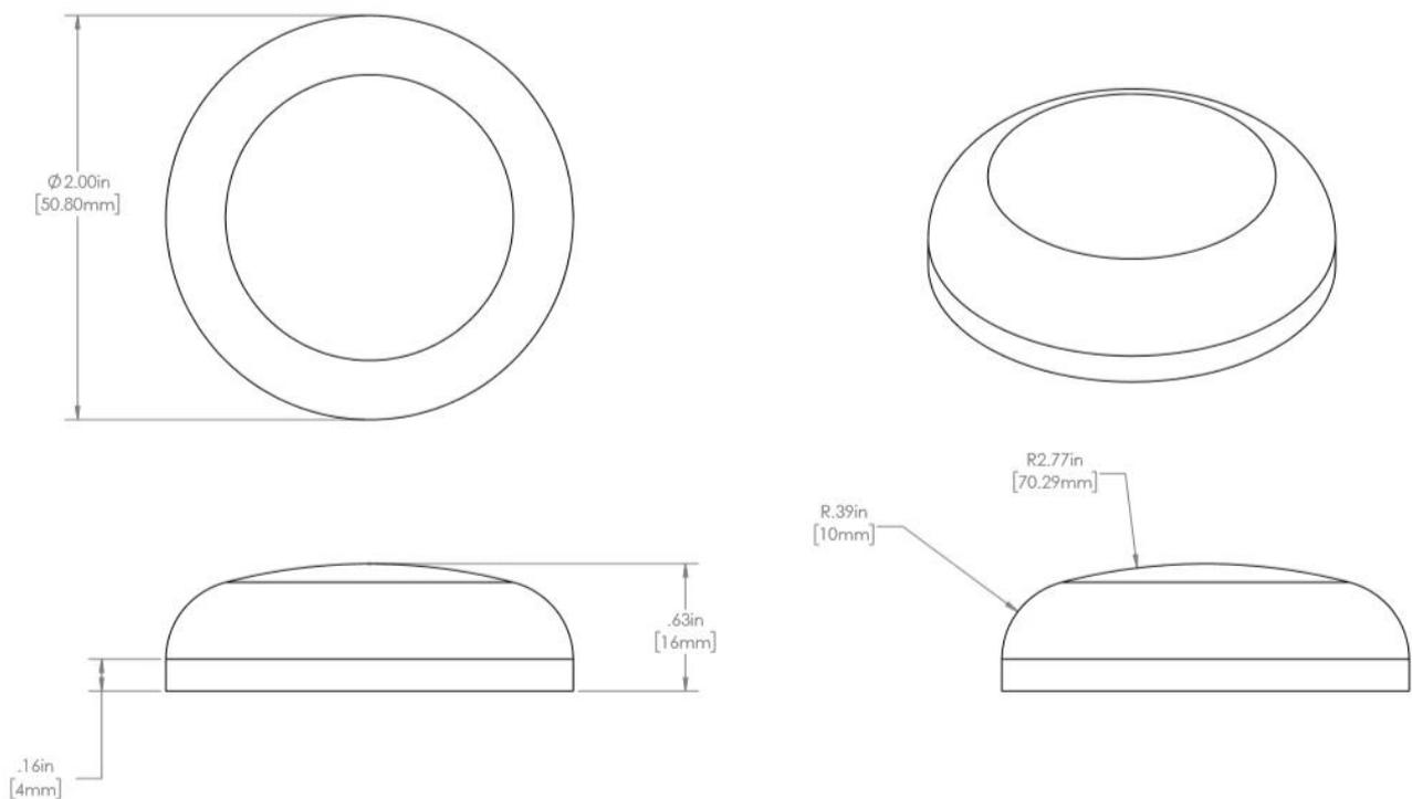
Autres modèles de capuchons de tuyaux en acier inoxydable pour raccords de main courante:
