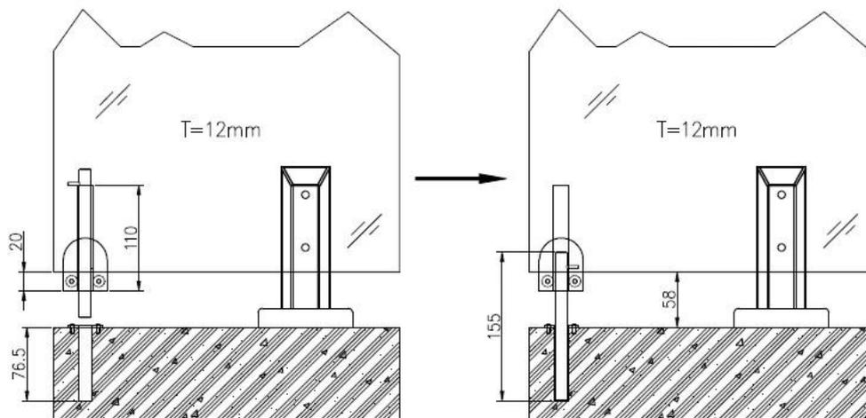
Porte en verre bouchon est utilisé en bas de la porte en verre, de le tenir ouverture ou la fermeture;
