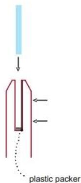
SpiGOT en verre avec plaque de nivellement de réglage
