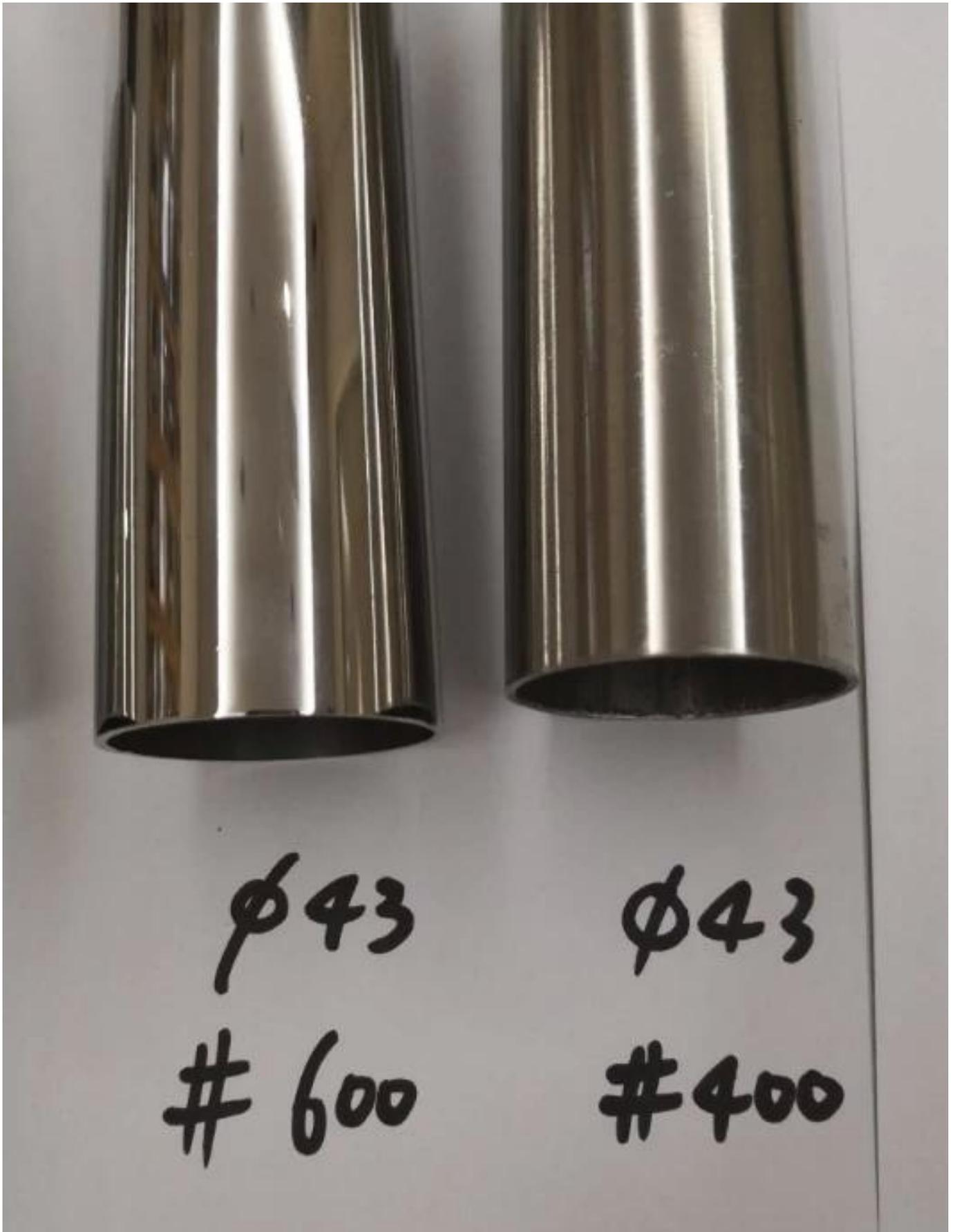
Photos de production pour tuyau de main courante en acier inoxydable
