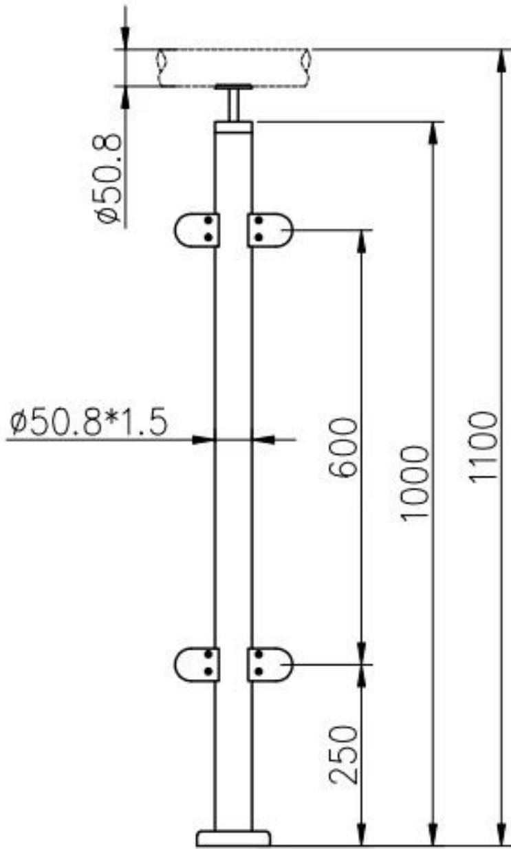
3. Poste de coin à 90 degrés **LCH-108** (135 degrés et degré de client disponible)
