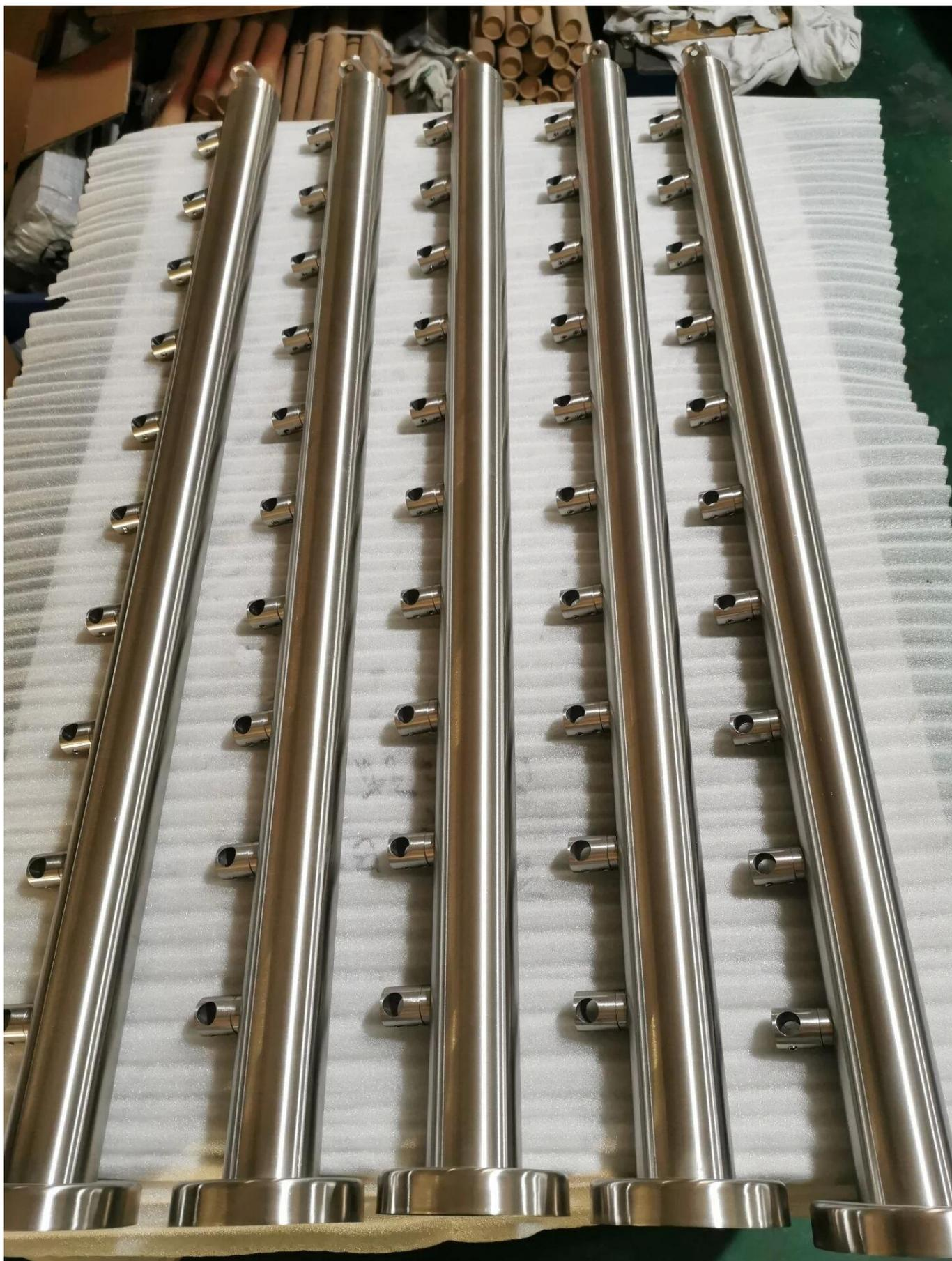
5Photos de projet pour Système de garde-corps en acier inoxydableSupport de barre transversale
