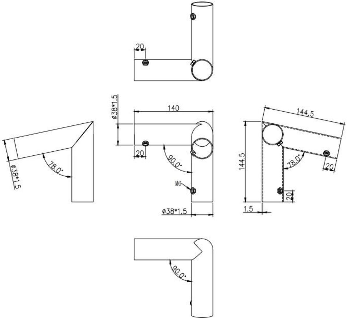
**Connecteur de montée à 3 voies:**
