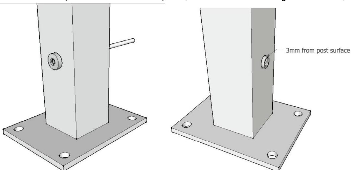
**Pas besoin d'écrou de l'autre côté, de toute façon, vous avez besoin de percer un trou sur le poste pour le tendeur de câble.**
