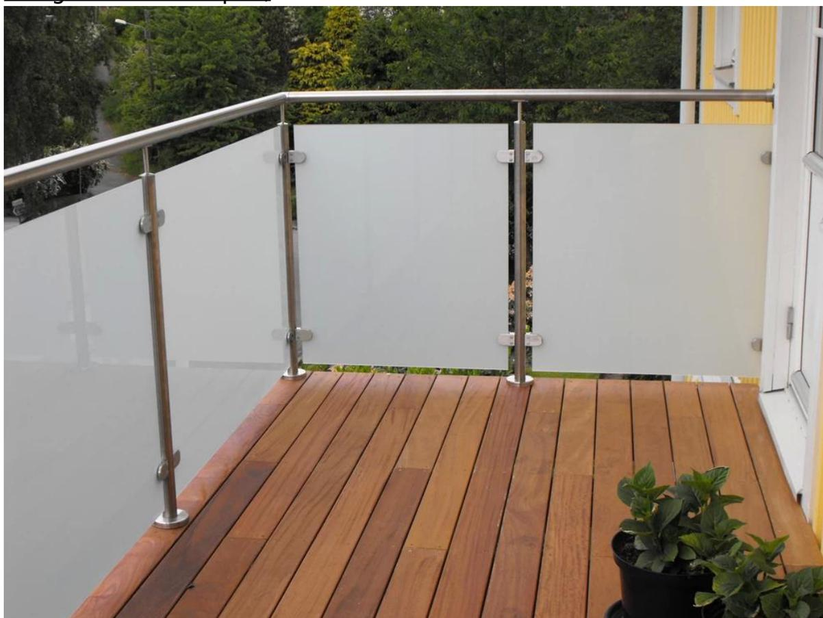
2) acier inoxydable balcon après balustrade en verre d'escalier de pont avec
