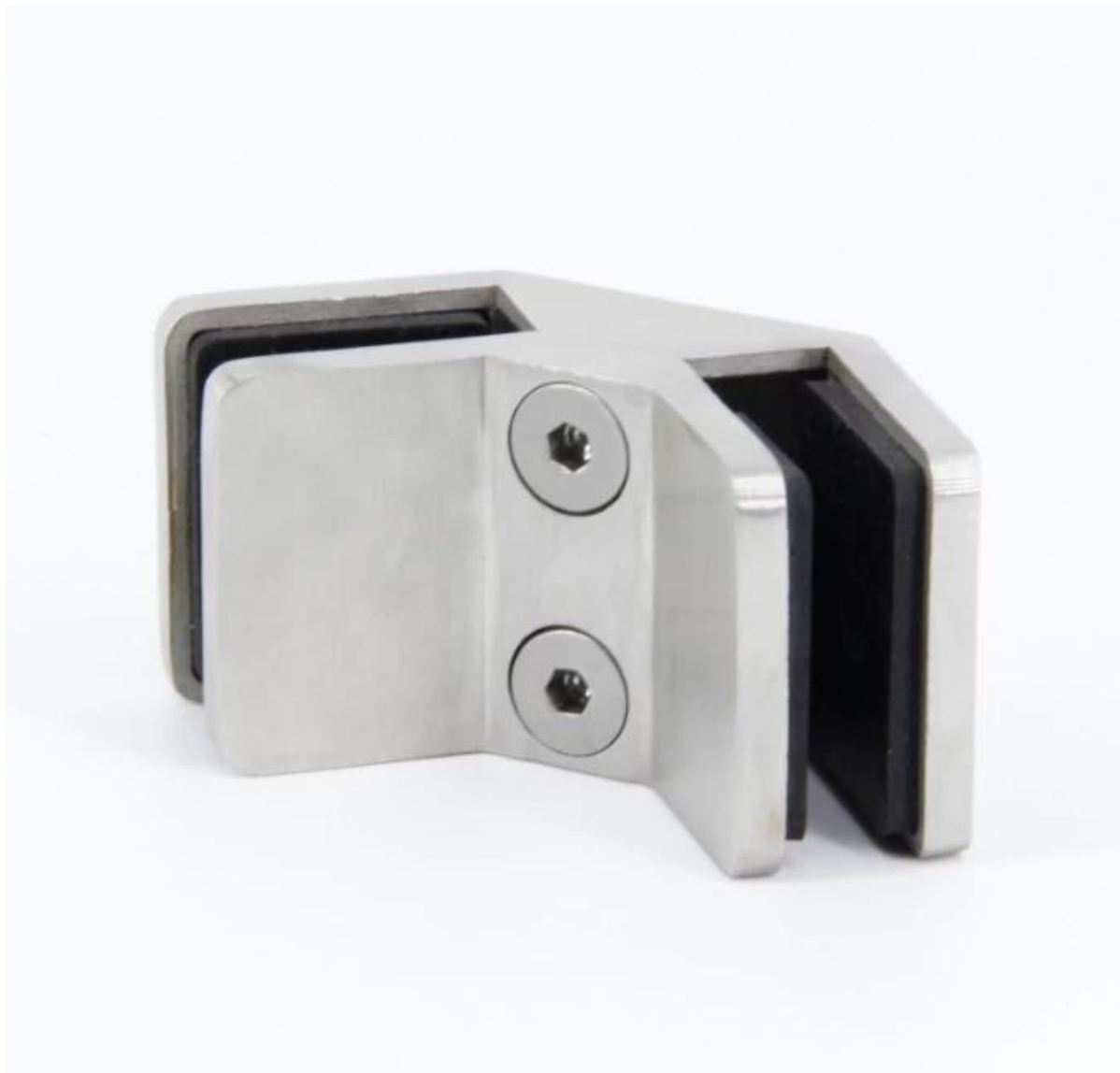
3. διαστάσεις για 12-15mm γυαλί 90 μοιρών γυαλί σφιγκτήρας από ανοξείδωτο χάλυβα
