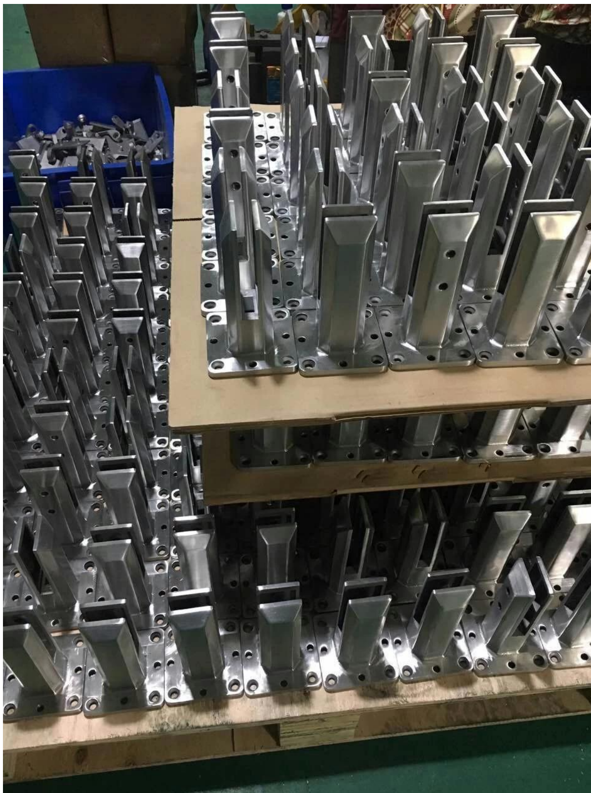
Φωτογραφίες έργου από σφιγκτήρες μπαλκονόπορτας Duplex 2205 με γυάλινο μπαλκόνι
