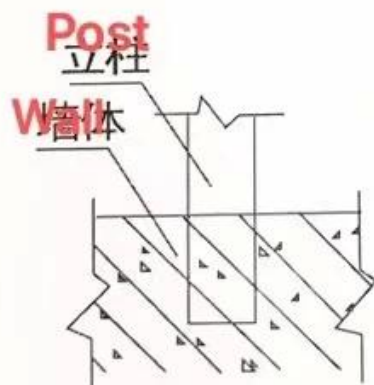
立柱入墙固定
