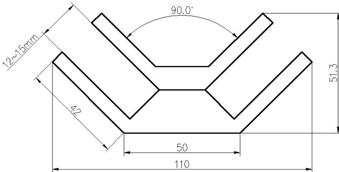
3) .Foto di produzione del connettore del morsetto di vetro senza cornice quadrato a 90 gradi -
