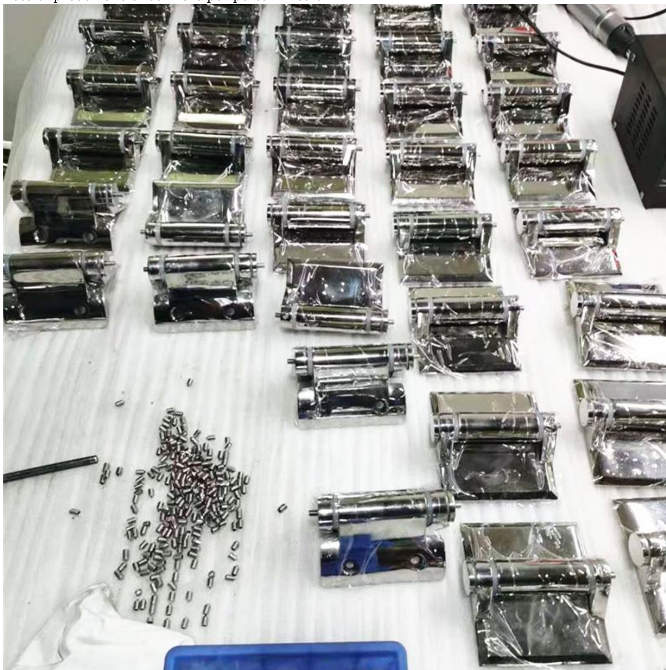
Foto di produzione di cerniere per porte in vetro-
