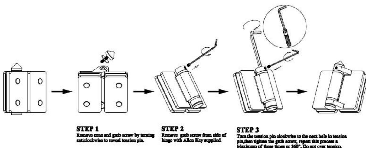
Dettagli di installazione della cerniera in acciaio inossidabile:
