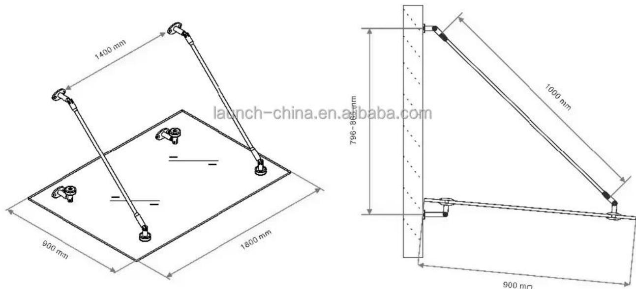
**Diversi modelli personalizzati di baldacchini in vetro, raccordi a baldacchino in acciaio inossidabile rinforzato Soluzione di progettazione di modelli in vetro a baldacchino -**
