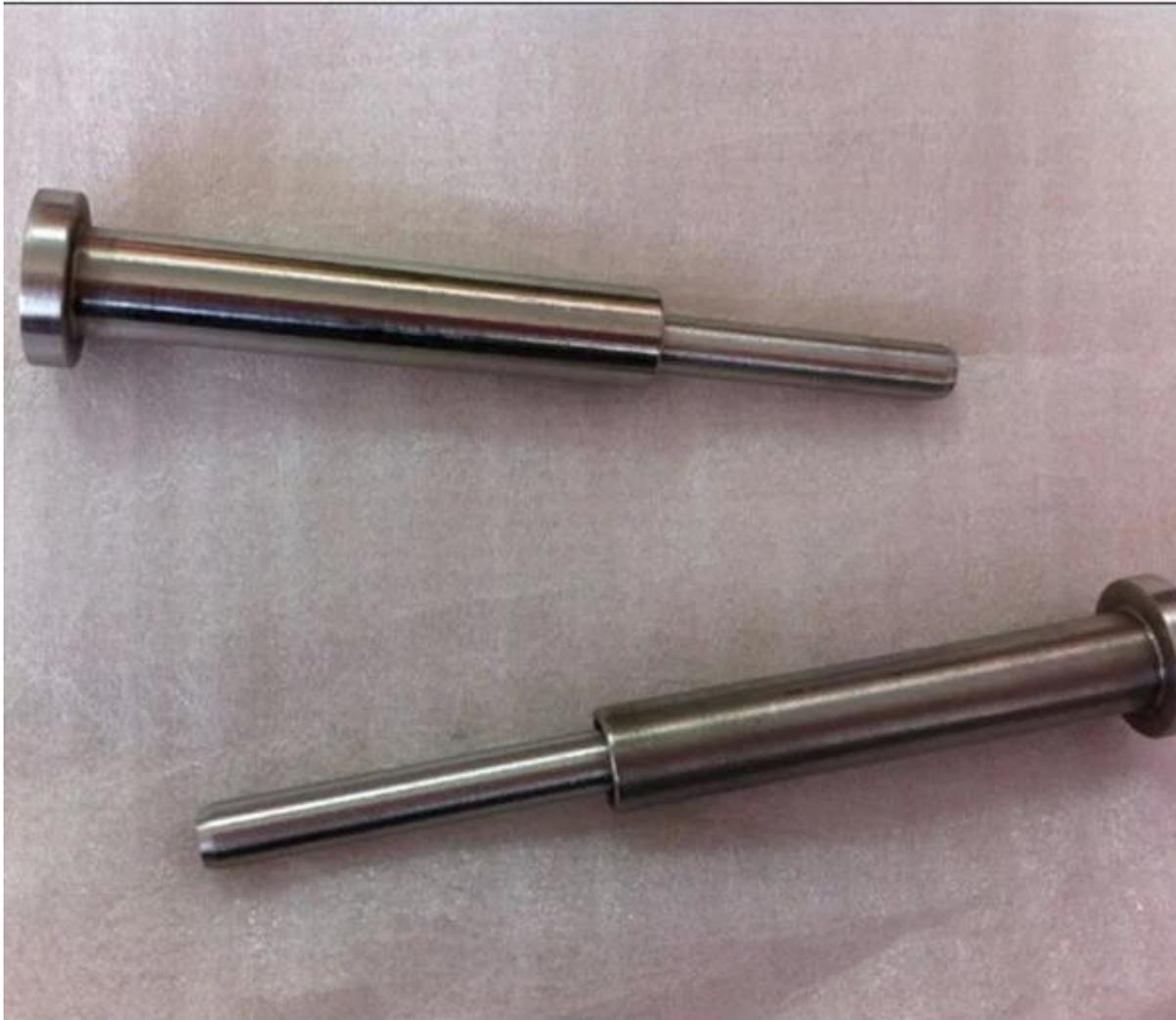
**Si compone di 2 parti, corpo e parte pressare;**
