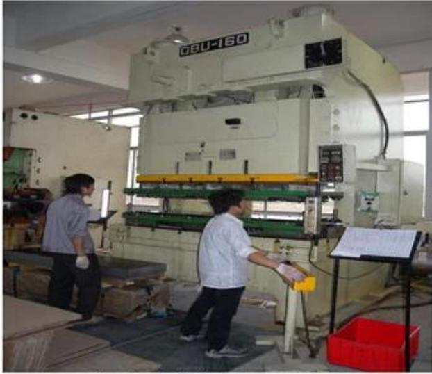
160T 宽台面冲床 模具加工尺寸800\*1800mm
