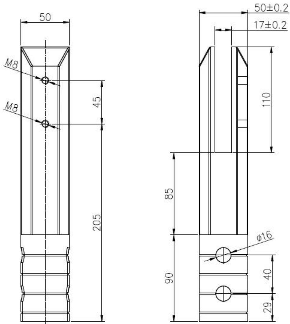
Questo modello di rubinetto può essere utilizzata per piscina recinzione e balcone recinzione. E 'molto più forte di base di montaggio del perno. Le sue dimensioni più pesante e più grande base di montaggio modelli.
