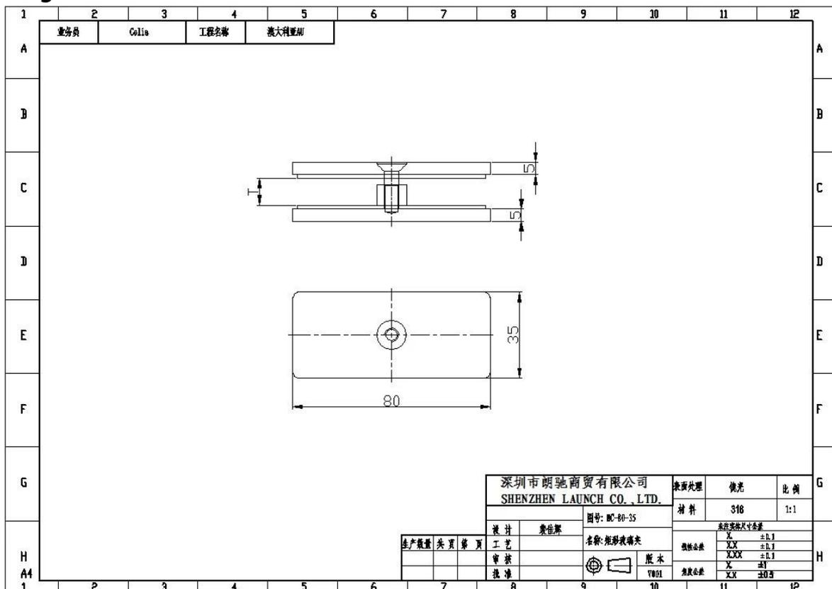
BC-80 \* 35 viene utilizzato tra il pannello 2 di vetro, per realizzare una connessione di loro. Più stabile e più sicuro;
