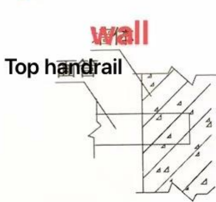
面管入墙固定
